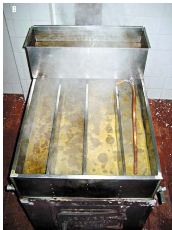
Figura 16. Evaporador. A. Vista completa del evaporador: horno, bandeja de evaporación, tanque de recepción y chimenea. B. El evaporador en funcionamiento.
