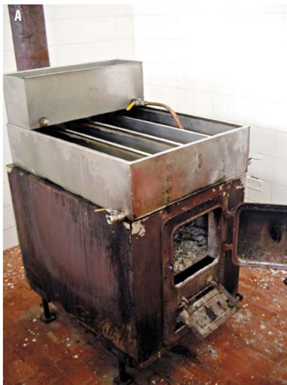
Figura 16. Evaporador. A. Vista completa del evaporador: horno, bandeja de evaporación, tanque de recepción y chimenea. B. El evaporador en funcionamiento.
