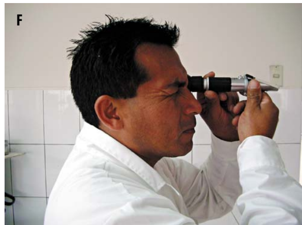
Figura 5. Método rápido y sencillo para estimar el contenido de azúcares en un lote de raíces de yacón. A. Seleccionar aleatoriamente un número mínimo de cinco raíces de yacón y pelarlas. B. Cortar una rodaja central de 1 cm de espesor de cada una de las raíces seleccionadas. C. Dividir en varios fragmentos cada una de las rodajas obtenidas anteriormente. D. Sacar el jugo de las rodajas cortadas con la ayuda de un exprimidor de limones. E. Colocar un par de gotas del jugo extraído sobre el prisma de un refractómetro portátil. F. Realizar la lectura. El valor medido (en °Brix) es un estimador del porcentaje de azúcares totales del jugo y tiene una correlación alta con el contenido de FOS.
