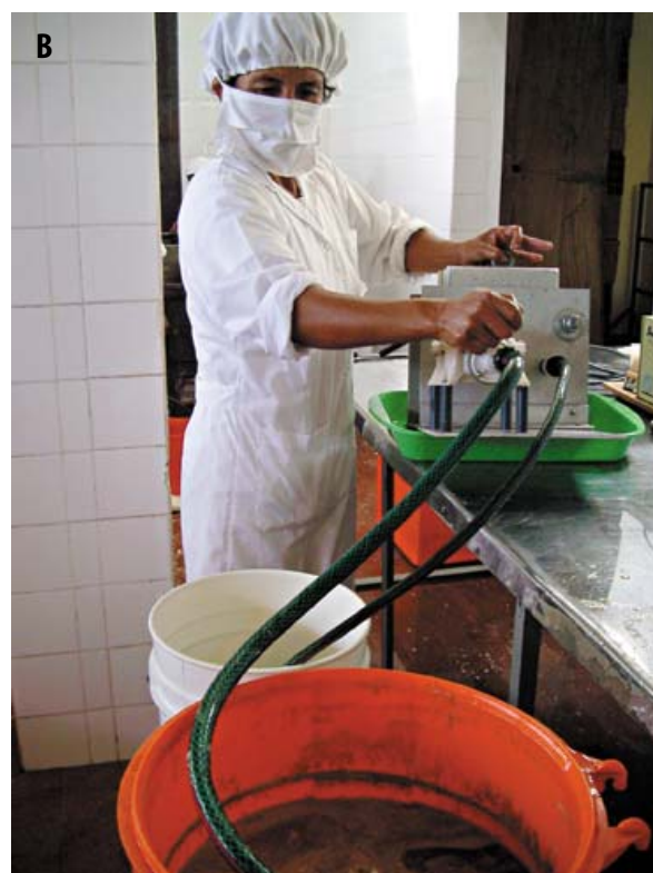
Figura 8. Extracción y filtración del jugo de yacón. A. A medida que el jugo es extraído, éste entra en contacto con una solución de zumo de limón con el fin de ayudar a prevenir el pardeamiento. B. El jugo extraído es filtrado inmediatamente en un filtro prensa.
