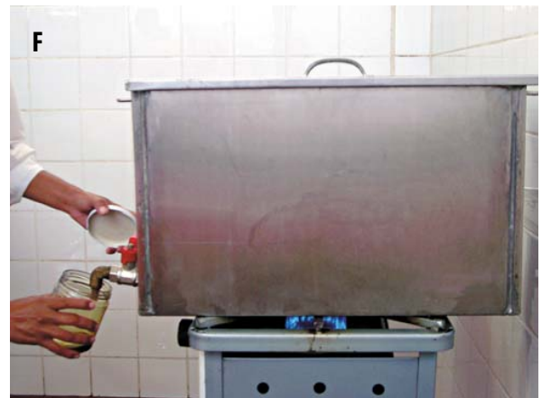
Figura 10. Diferentes etapas del procesamiento. A. Evaporación del jugo de yacón. B. Obtención del prejarabe (50 a 60° Brix). C. Alimentación del horno con bloques de leña. D. Filtración. E. Concentración del prejarabe en bandejas pequeñas hasta llegar a los 68 a 70° Brix. F. Concentración final del jarabe (72 a 74° Brix) y envasado.
