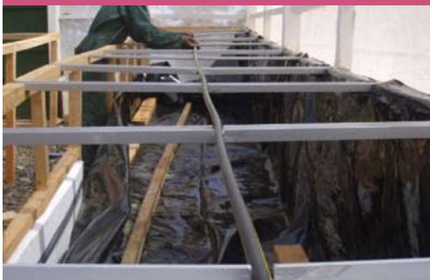
**Figura 20** Un cajón de aeroponía recubierto internamente con plástico grueso. Notar cómo va colocada la manguera central para los nebulizadores.
