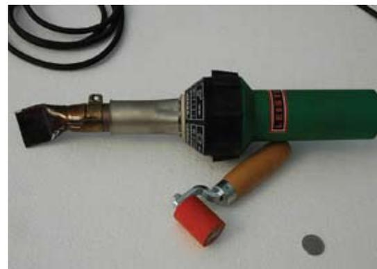
Figura 17 Soldador de plástico, útil en el revestimiento interno con plástico.
