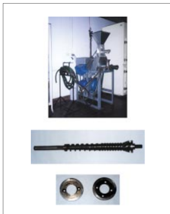
Figura 6. Vista del extrusor, tornillo para el transporte del producto (longitud 30 cm) y dados de salida del producto.
