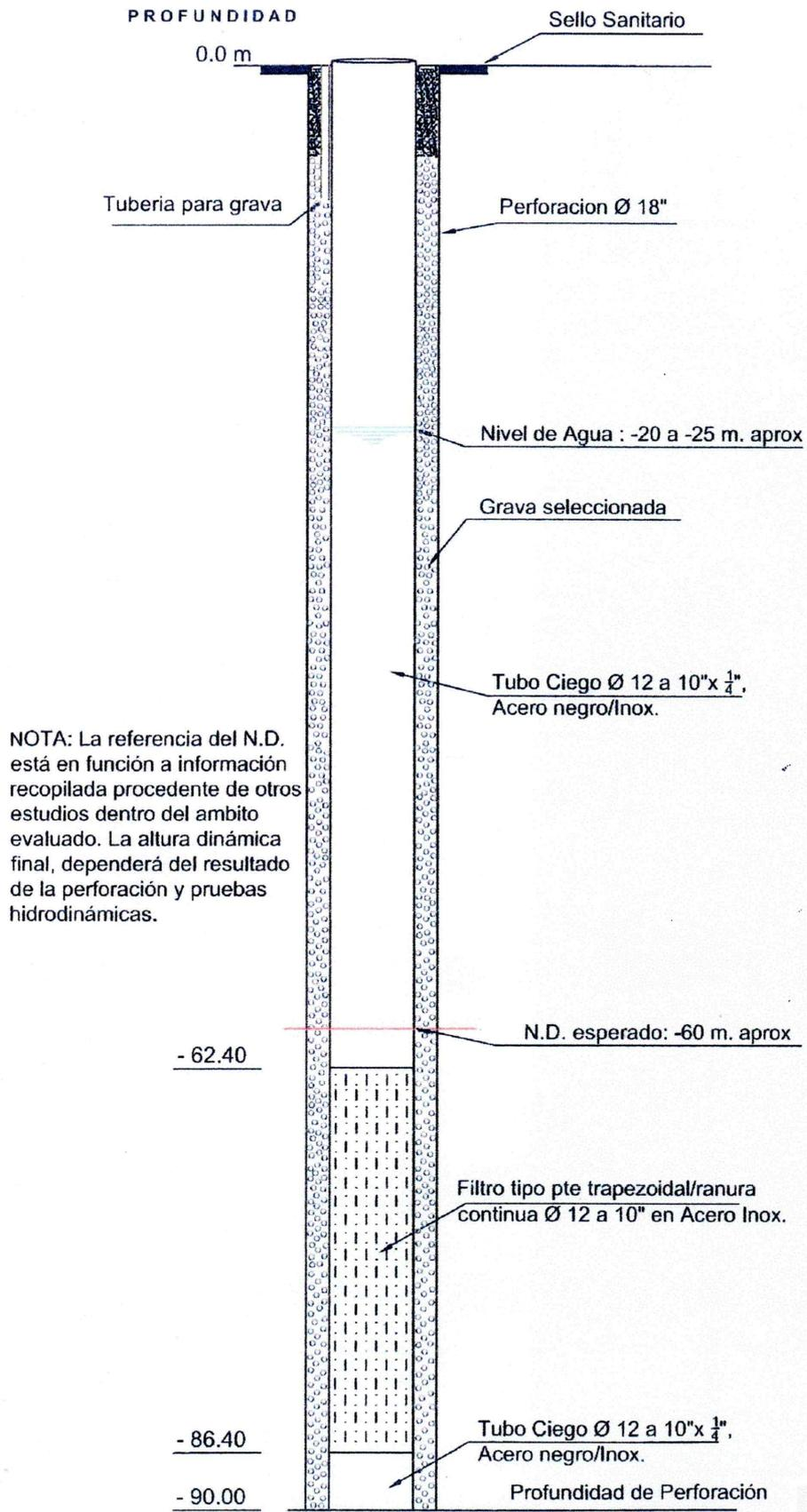
NOTA: La referencia del N.D. está en función a información recopilada procedente de otros estudios dentro del ambito evaluado. La altura dinámica final, dependerá del resultado de la perforación y pruebas hidrodinámicas.
