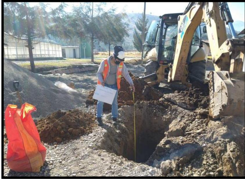
*Extracción de muestra para determinar capacidad portante del suelo*
