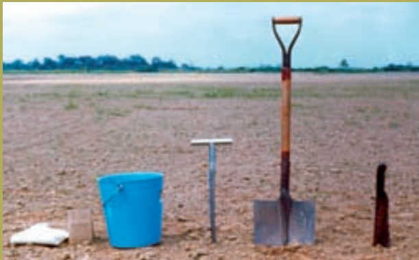
Materiales y herramientas necesarias para toma de la muestra de suelos
